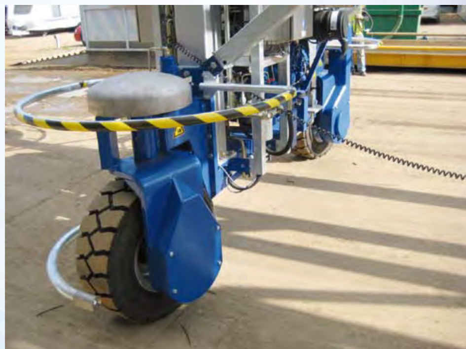
Wickelgerät mit Lenksensor Winding unit with steering sensor
